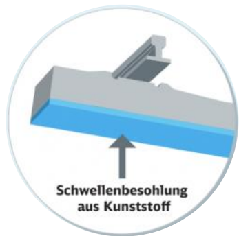
Masse-Feder-System mit elastischer Kunststoffmatte
